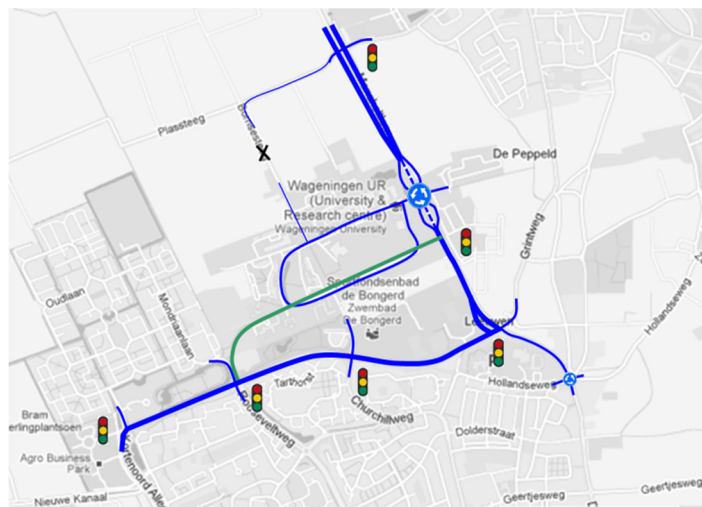
Figuur 10 Variant A2: opwaarderen huidige tracé, rotonde Droevendaalsesteeg met tunnelbak doorgaand verkeer
