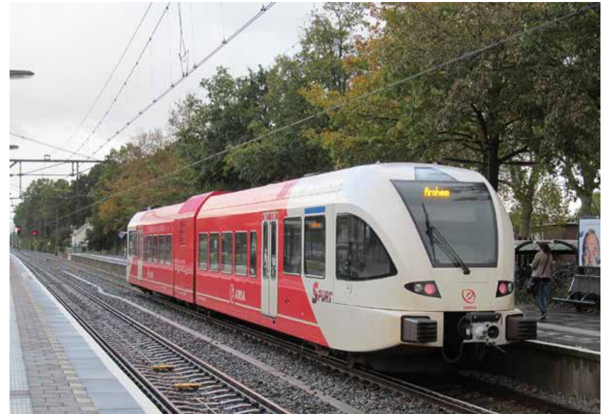
Figuur 2: Een trein die bestaat uit 2 eenheden (bakken). Dit zijn ook de type treinen (GTW-R-DWU) die rijden op dit traject
